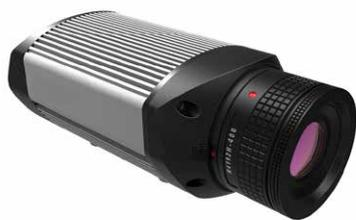
**Тепловизоры KARNEEV KS UR-M** серии используются для визуализации тепловых процессов и измерения температуры вплоть до 2000 градусов Цельсия. Точность измерения достигает 1%.
