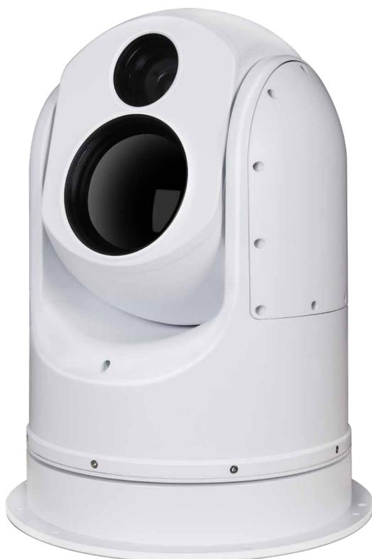
Тепловизоры S серии можно без проблем установить прямо на судне под открытым небом. Тепловизоры защищены от попадания внутрь пыли и воды.
